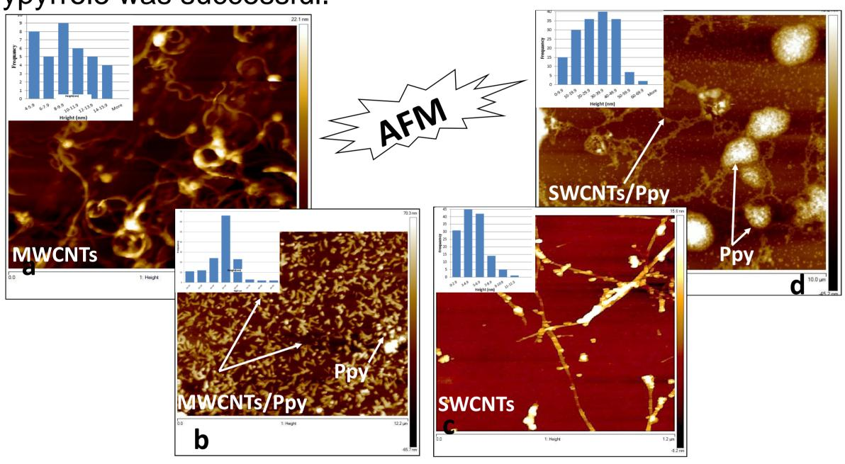
AFM height images of (a) MWCNTs, (b) MWCNT/Ppy composite, (c) SWCNTs, (d) SWCNT/Ppy composite.
